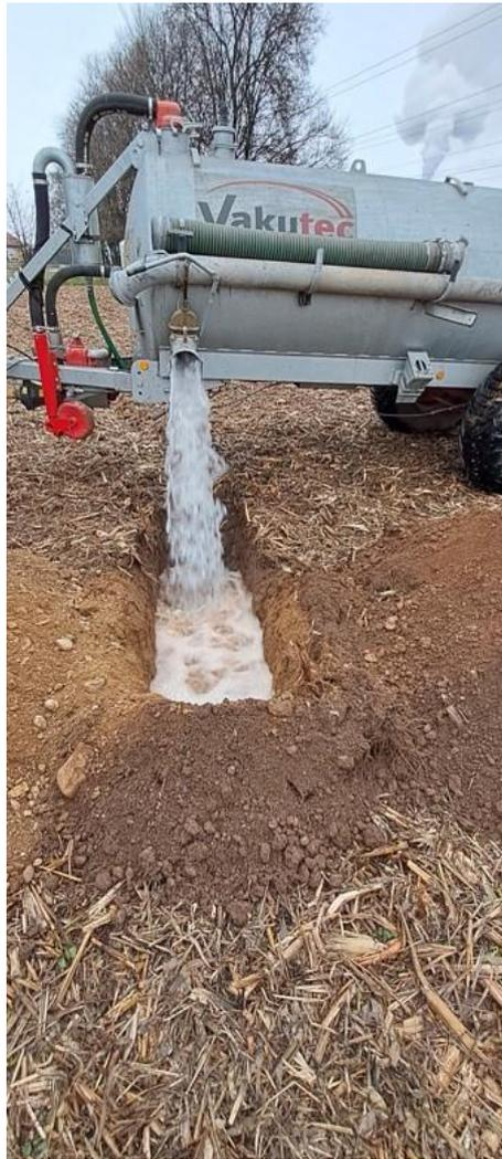
Abbildung 7: Versickerungsversuch VV01 in Schurf S03
