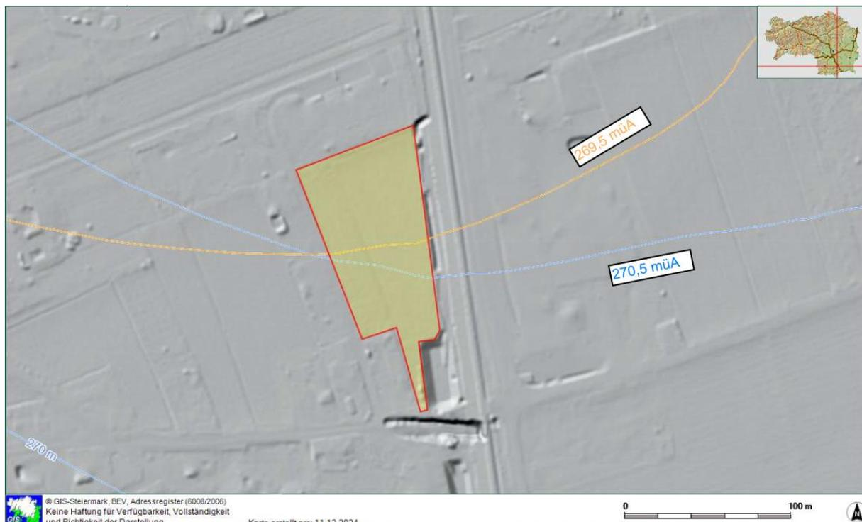
**Abb. 3:** Grundwasserschichtenplan, Lage Bauvorhaben (Markierung), *Quelle: /4/*
